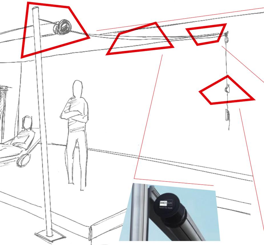
Flexibel gelagerte Tuchwelle. Spannseile und Tuch bleiben in jeder Ausfahrposition gespannt.
